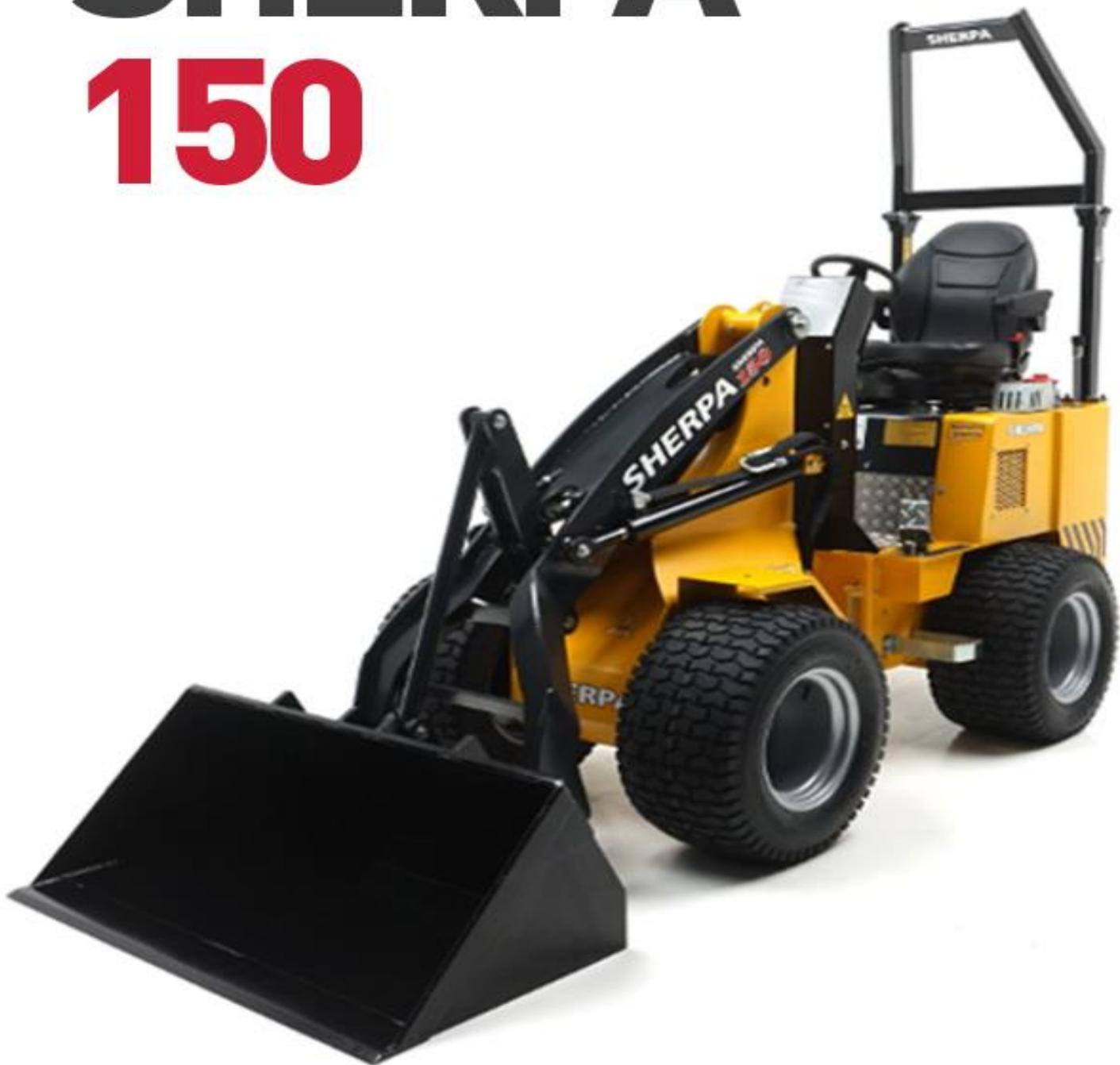
Сочлененный погрузчик SHERPA 150 характеризуется компактными размерами. С рабочей шириной 76 см это самый узкий сочлененный погрузчик на рынке. Широкие шины обеспечивают стабильность и низкое давление на грунт, что предотвращает разрушение почвы.
